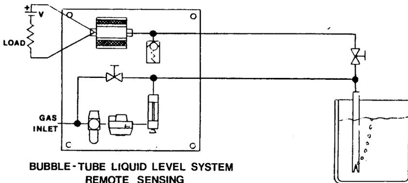
BUBBLE-TUBE LIQUID LEVEL SYSTEM
