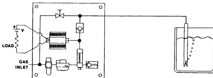
BUBBLE-TUBE LIQUID LEVEL SYSTEM
